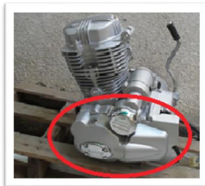
Figura: 3.5, Caja de cambios de la moto. (Esteban Calero y Diego Morales, 2013)
