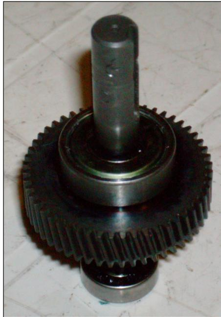
Figura 6.4.2.3. Eje De Salida N4
