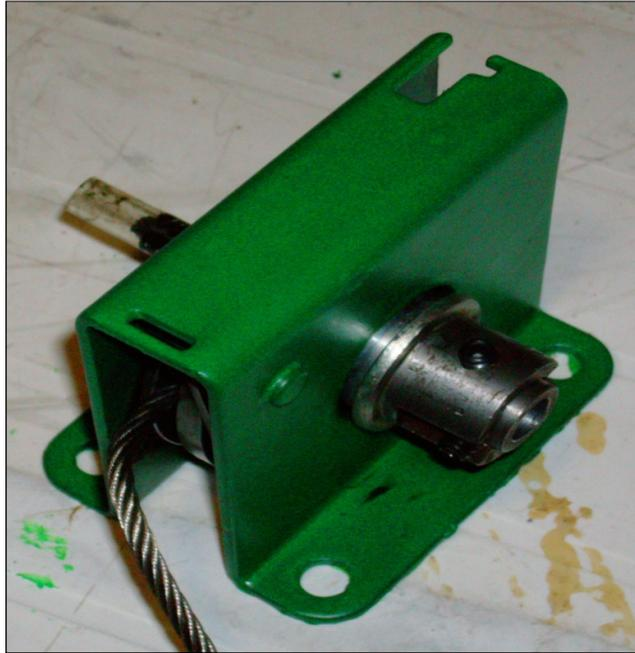
Figura 6.4.3. Tecla Tensador
