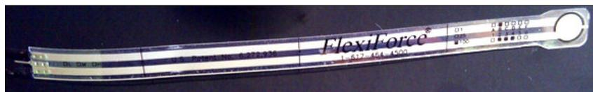
Figura 4.4 Sensor Asiento Ocupado (Sensor de Peso)
