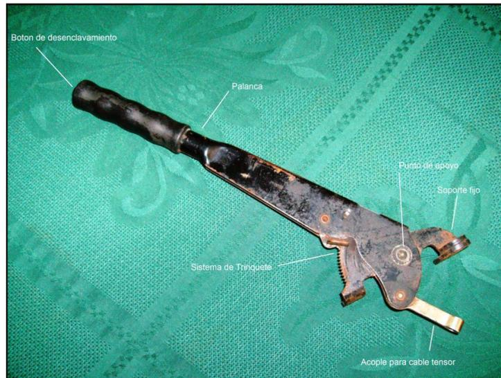
Figura 2.2 Palanca De Freno De Mano
