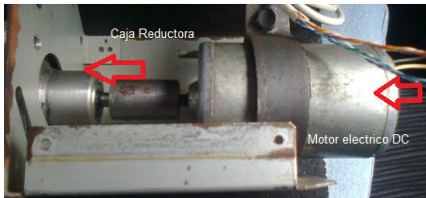
Figura 6.5 Acople Motor Eléctrico A Caja Reductora
