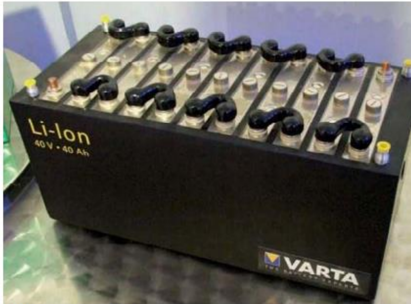
Figura 4. Batería de iones de litio para un vehículo eléctrico.
