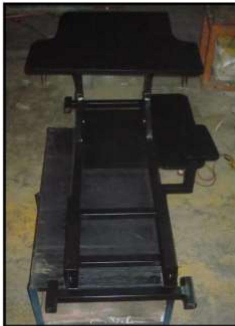
Figura 3. 55 Soportes MDF en estructura
