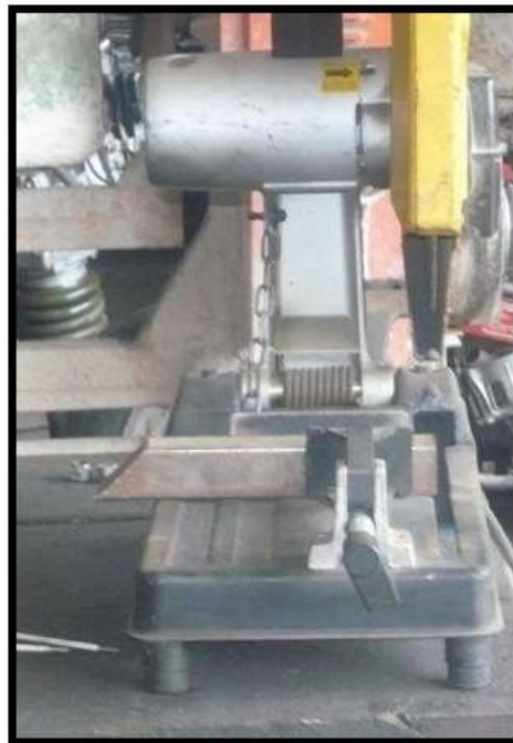
Figura 3. 50 Corte del tubo en las partes que conforman la base metálica
