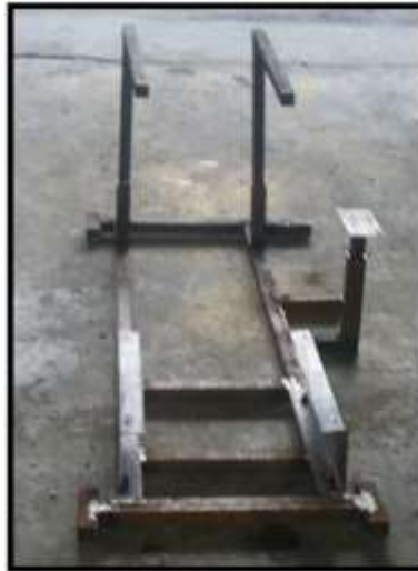
Figura 3. 51 Estructura base debidamente soldada
