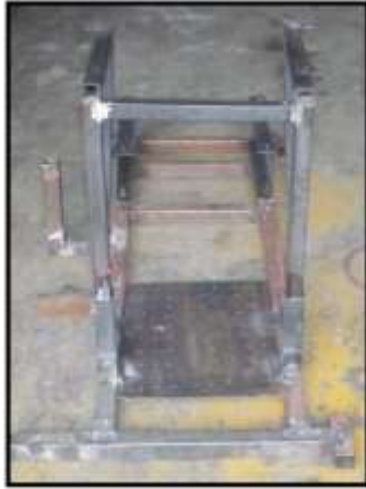
Figura 3. 52 Soporte de los pedales ubicado en la base metálica Fuente: Jorge Vasconez y Juan Paredes
