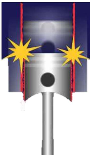
Figura 15. Fuerza de fricción sobre un elemento
