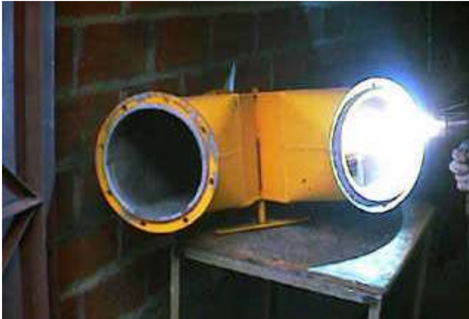
Figura 42. Relleno interior para aumentar resistencia al desgaste
