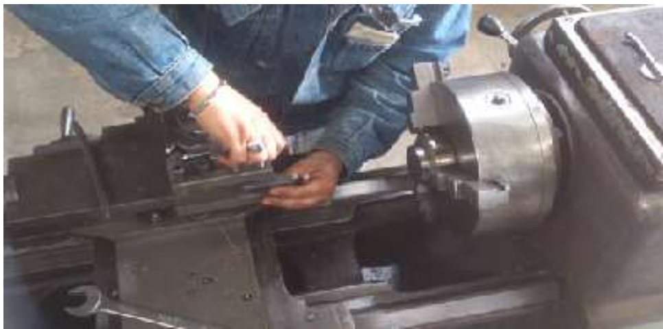
Figura 48. Corrección de la superficie de muestra de espectrometría
