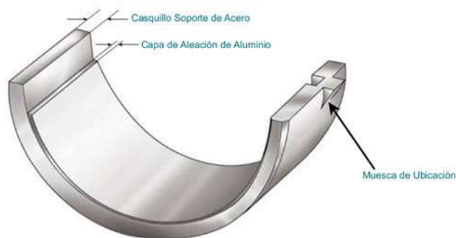
Figura 12. Cojinetes biela y bancada.
