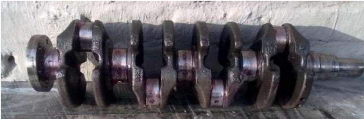
Figura 23. Zonas de desgaste muñón biela y bancada
