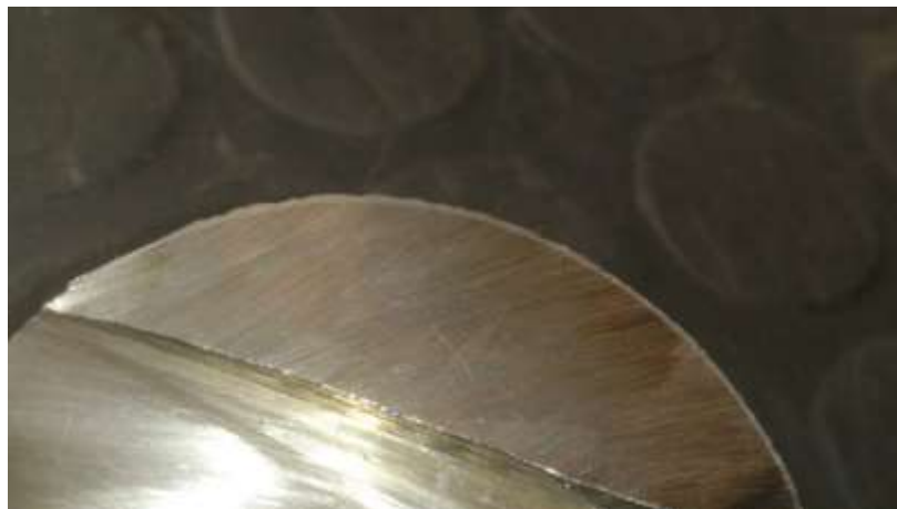
Figura 44. Metalización de un muñón de biela
