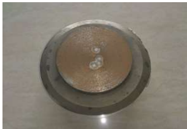
Figura 45. Muestra para espectrometría de chispa
