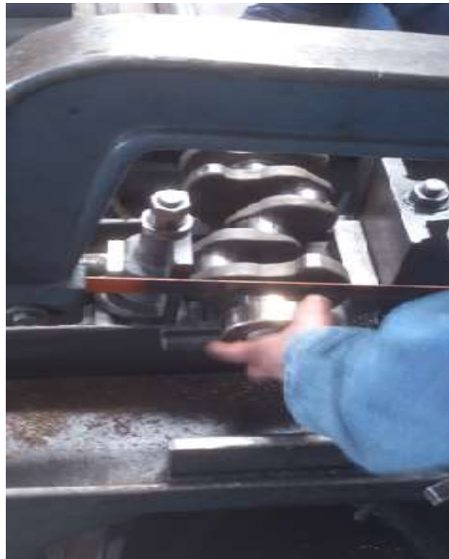
Figura 46. Corte de muestra mediante cierra de pedestal
