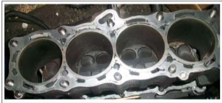
Figura 3.13. Montaje Bloque de Cilindros.
