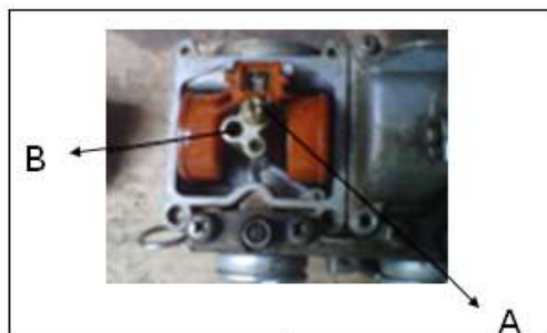
Figura 3.19- Surtidores y pozo de agua.
