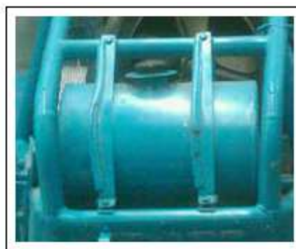
Figura 2.10. Tanque de Combustible.
