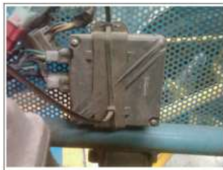
Figura 2.2- Módulo de Encendido.
