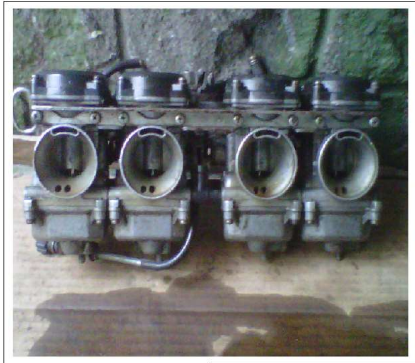
Figura 3.24- Montaje Rampa de Carburadores.
