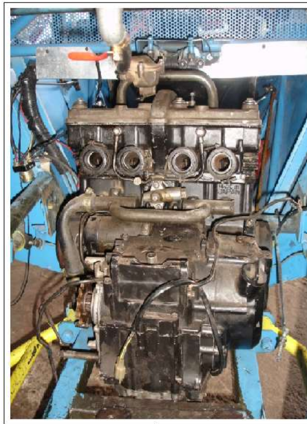
Figura 3.1- Motor Kawasaki 600 c/c.
