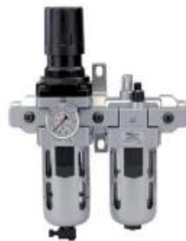
Figura 1.27. Filtro de aire, regulador y lubricador para compresor. Filtra la humedad y las partículas de aire comprimido, regula la presión de aire y lubrica de forma automática las herramientas neumáticas. Fuente: Bt-ingenieros.
