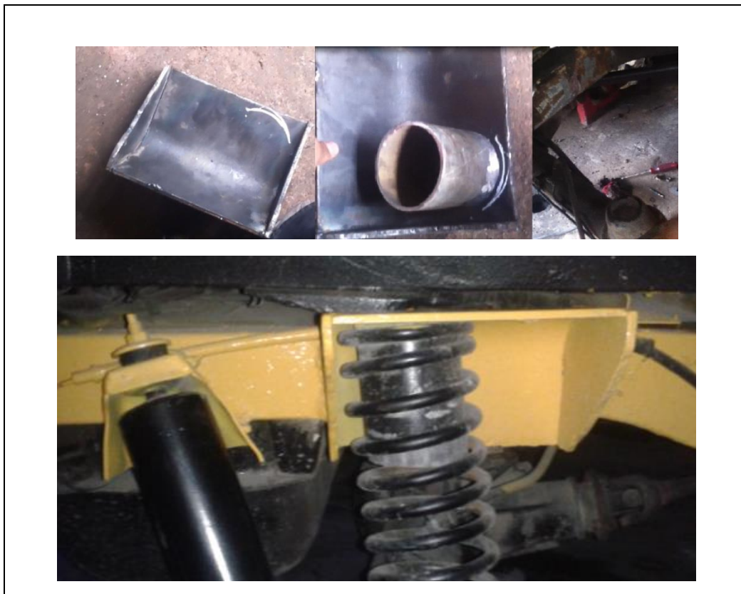
Gráfico 2.28 Soporte resorte E RH – ENSAMBLE 001P
