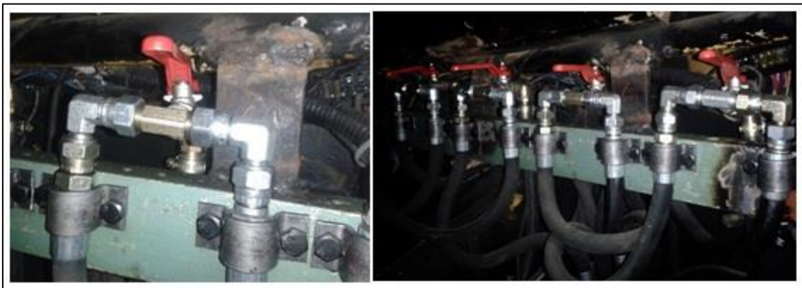
Gráfico 3.30 Válvulas de alivio con acoples unidos con teflón
