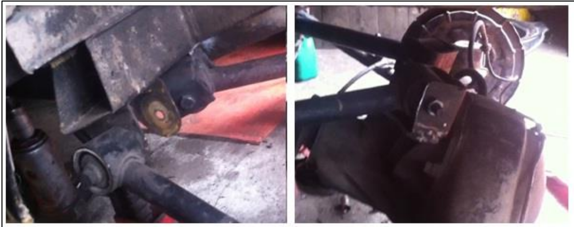
Gráfico 3.23 Soporte barra tensora
