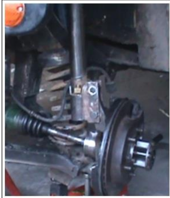
Gráfico 3.17 Suspensión delantera armada
