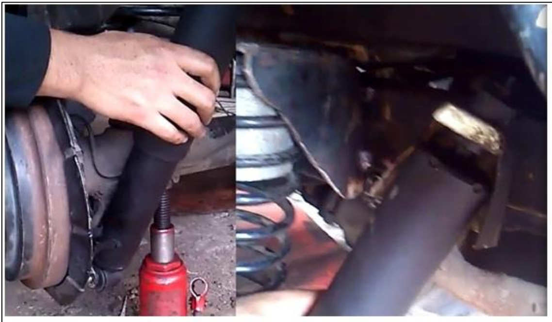
Gráfico 3.24 Instalación amortiguadores posteriores
