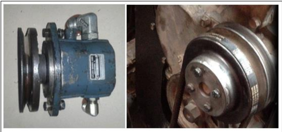
Gráfico 3.27 Instalación Polea motor a bomba hidráulica
