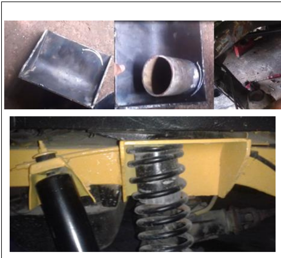
Gráfico 2.30 Soporte resorte RH – ENSAMBLE 002P
