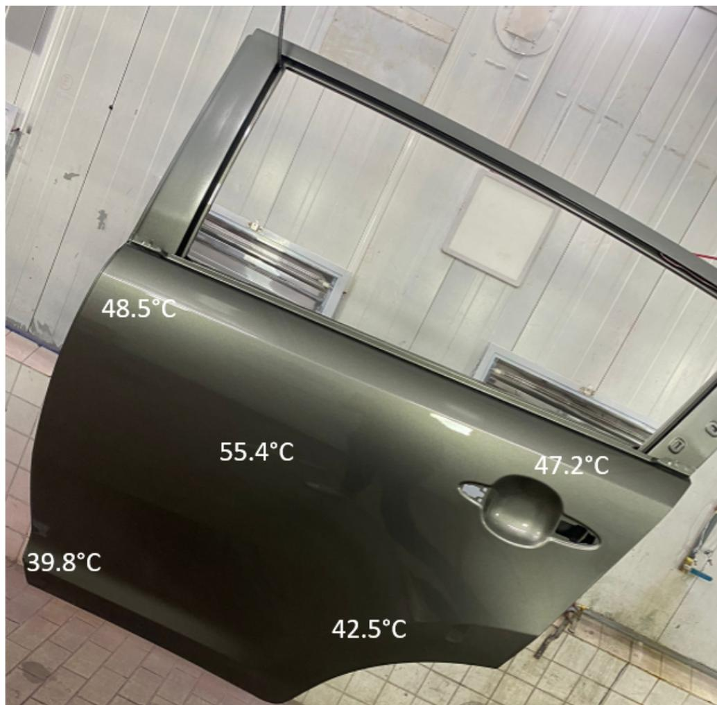
**Figura 31:** Distribución de calor por una pieza
