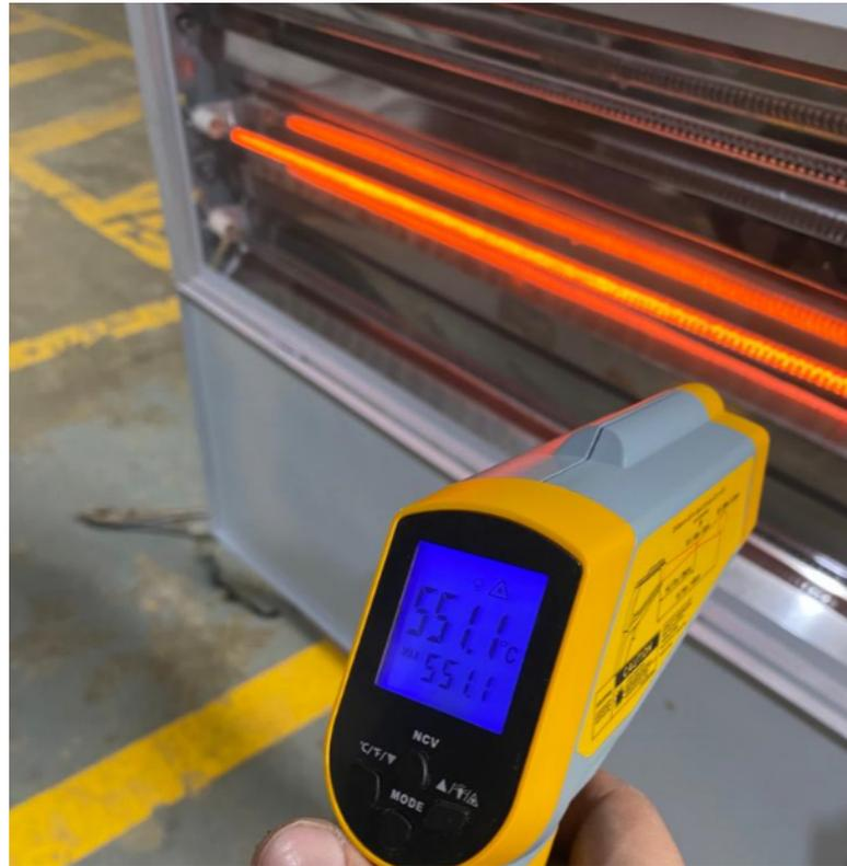
**Figura 29:** Temperatura máxima alcanzada por cada lámpara
