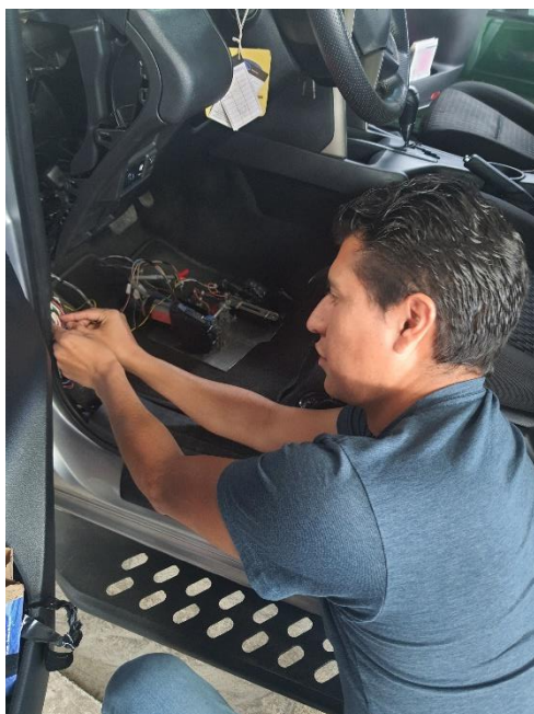
Ilustración 42. Instalación de Sistema del pedal
