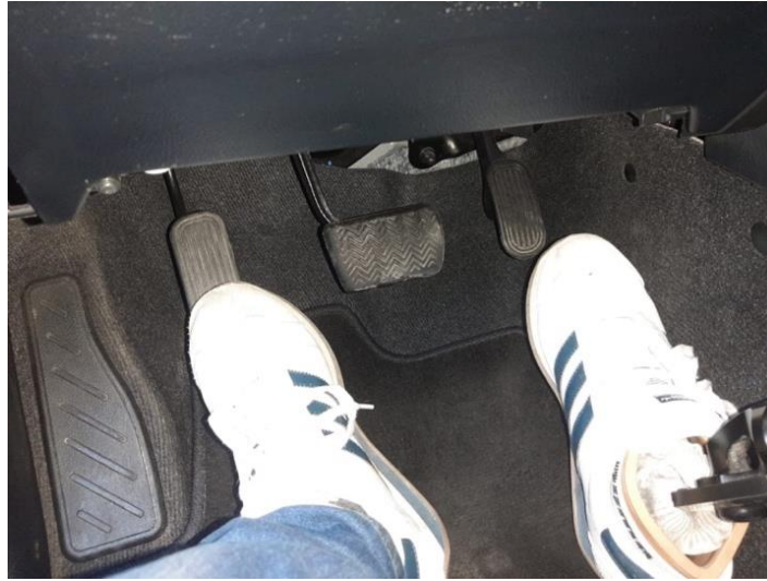
Ilustración 47. Operatividad de pedal adaptado
