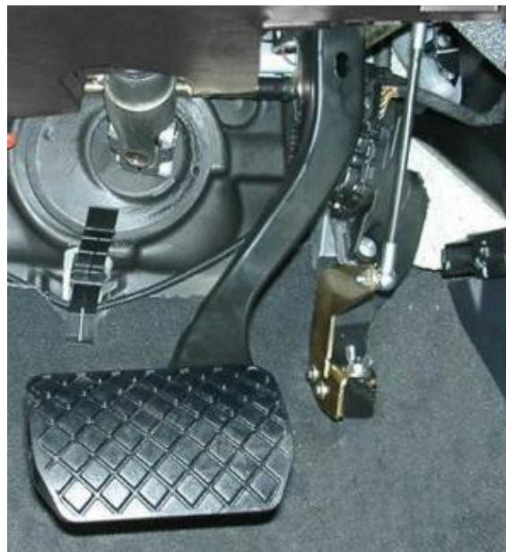
Ilustración 5. Acoplamiento mecánico para acelerar y frenar
