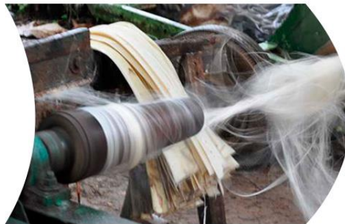
Gráfico 5 Proceso de Desfibrado
