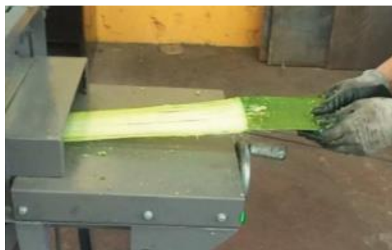
Gráfico 14 Maquinaria de extracción de fibra
