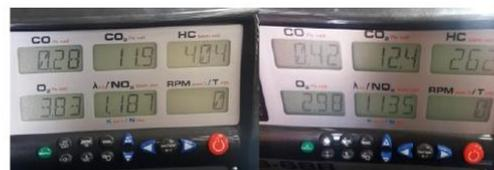
**Figura 3.** Datos que se obtienen del analizador de gases.
