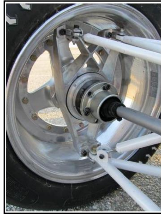
Figura 1.6. Ensamble de la rueda trasera con eje de transmisión y brazos de suspensión.
