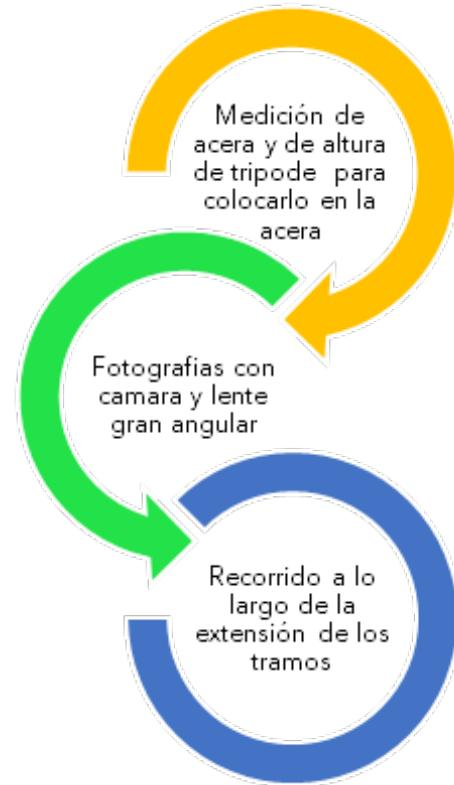
Figura 74. Proceso de levantamiento fotográfico
