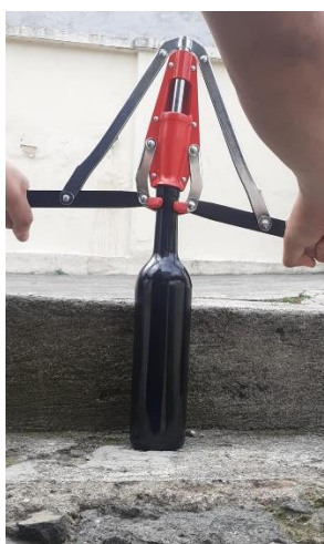
Ilustración 25 – Utilización de prensa para la colocación del corcho en la botella de vino
