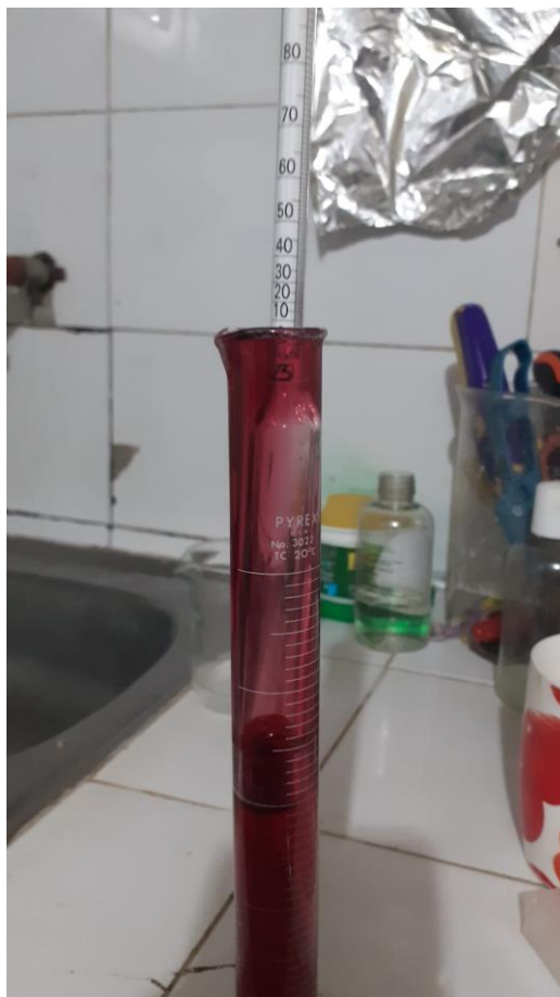
Ilustración 19 – Medición del grado alcohólico del vino
