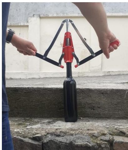
Ilustración 25 – Utilización de prensa para la colocación del corcho en la botella de vino
