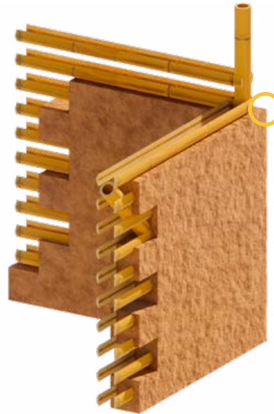
Ilustración 8: [Figura] Mampostería de bahareque. Fuente: Autor.
