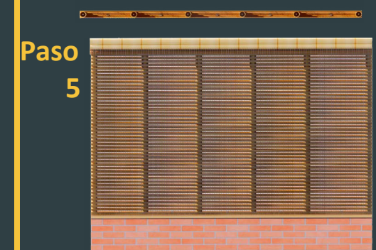
Ilustración 98: [Estrategia constructiva] Proceso constructivo y anclajes de mampostería de bahareque encementado Fuente: Autor.
