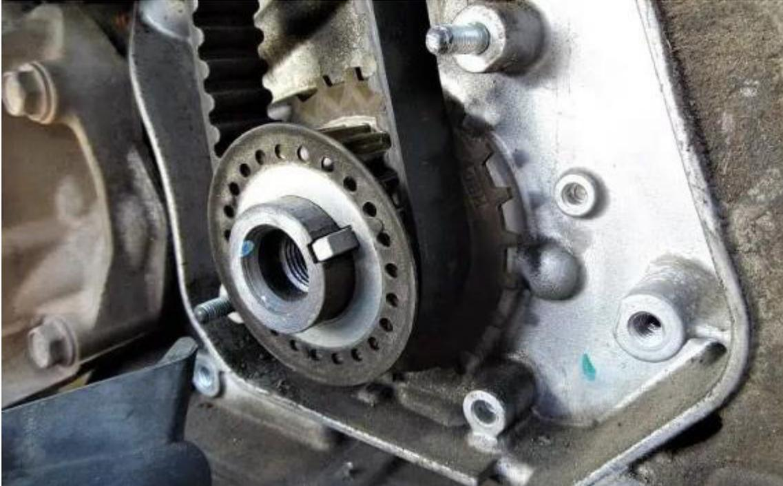
El árbol de levas y el cigüeñal están conectados por una correa de distribución. Ésta tiene **dos caras**: una **dentada** para agarrarse a los piñones que tiene ambos elementos en sus extremos y otra **plana** que es donde aprietan los rodillos tensores. Estos rodillos son necesarios para que la correa quede bien fijada a los piñones y que no pueda patinar en ningún momento.
