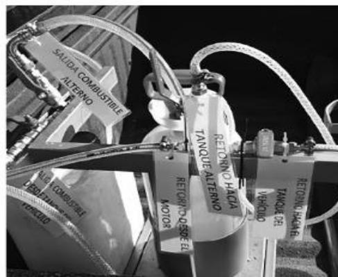
**Figura 2.** Válvulas y tanque alternativo del sistema adicional de combustible
