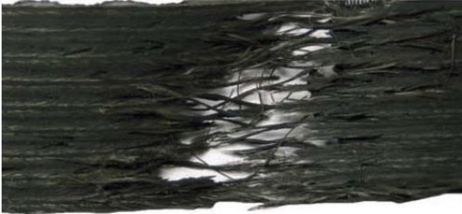
Causa 2: Bloqueo de componentes, se ha superado la resistencia a la tracción de la correa
