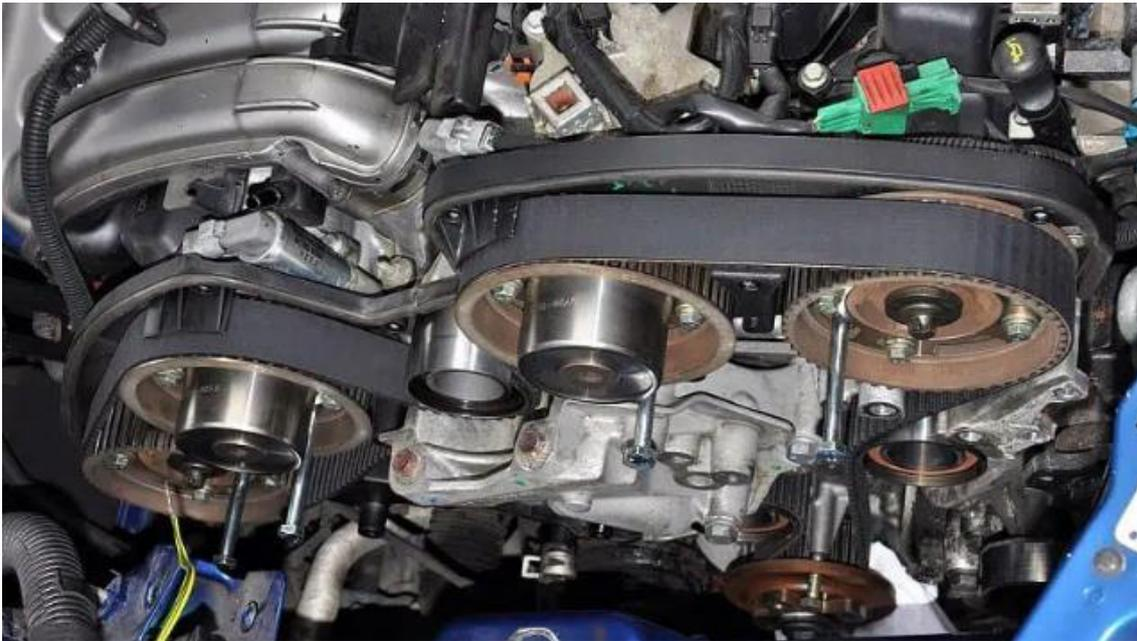
La **distribución de un motor** es la encargada de mantener todo coordinado para que funcione correctamente. Gracias a ella, las válvulas se abren y se cierran en el momento adecuado para tomar aire o expulsar los gases de escape. Sin embargo, **hay muchos tipos** de distribución, según cómo estén repartidos los componentes y qué sistema usen para moverse.
