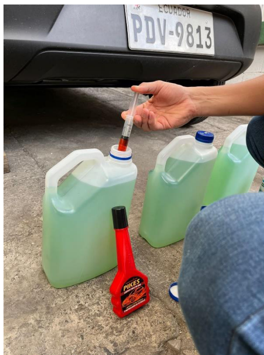
Imagen 3: Adición del aditivo en el combustible
