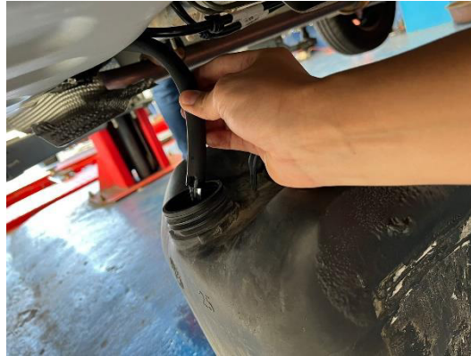
Imagen 6: Extracción de combustible
