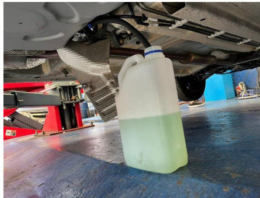
Imagen 4: Drenaje de combustible con adaptación al filtro
