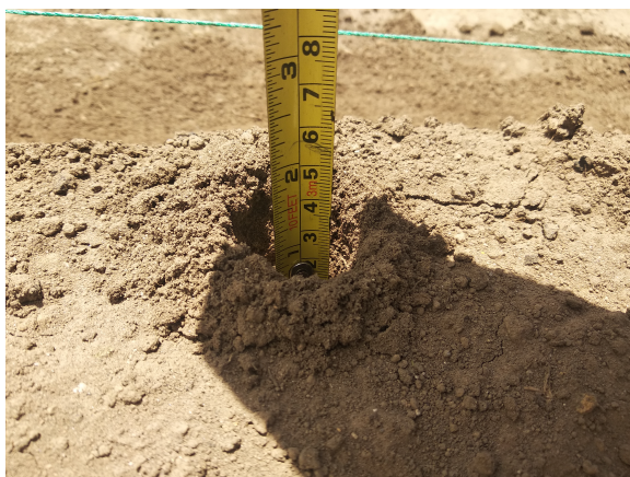
Figura 121: Prueba de penetración en el suelo
