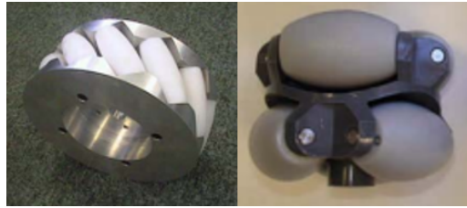
Figura 13: Rodillos con inclinación a 45° y 90°, [12].
