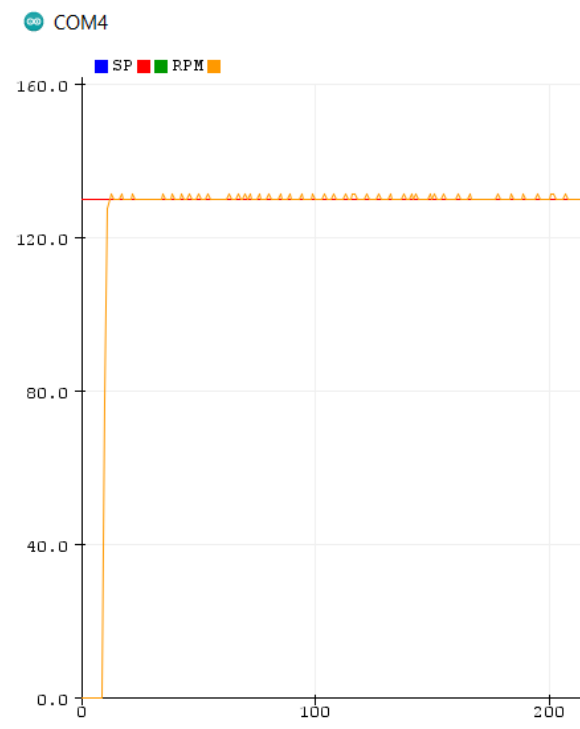
Figura 111: Respuesta del motor con control PID con un K_p=1,5 ; K_d=0,01 ; K_i=0,1 .
