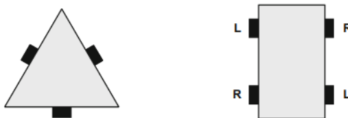
Figura 12: Disposición de ruedas robot móvil con configuración omnidireccional, [12].
