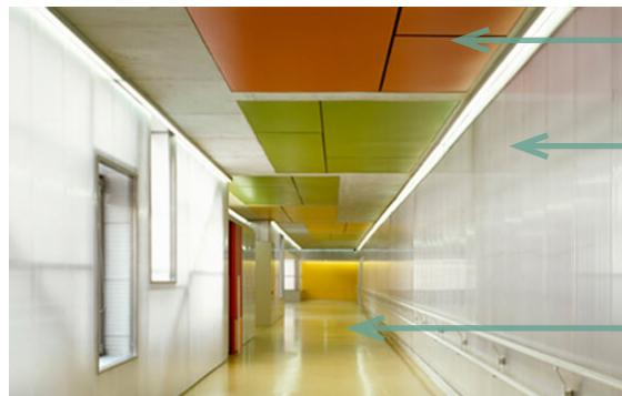
Techo: Losa de hormigón visto, con tableros de panel compacto fenólico en colores.
