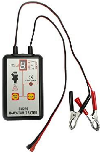
Figura 5. Controlador de pulsos de inyección. Duración del pulso: 250ms. Voltaje: 12V DC. Amperaje necesario con relé: 3.33 A.
