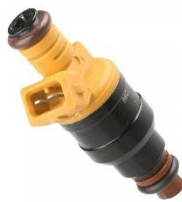
Figura 7. Inyectores de gasolina. Tipo: Disco de 4 orificios. Ángulo de rociado: 15 deg. Resistencia de la bobina: 14.5 Ohmios. Flujo másico: 215cc/min @ 43PSI. Tiempo de activación @ 14VDC: 1.14ms. Tiempo de desactivación: 0.85ms @ 300KPa. Amperaje: 1.0 Amp. Presión: Min 30PSIG/ Max 100PSIG. Variación: 2 %. Diámetro: 16mm. O-Ring Diámetro: 14.5mm.
