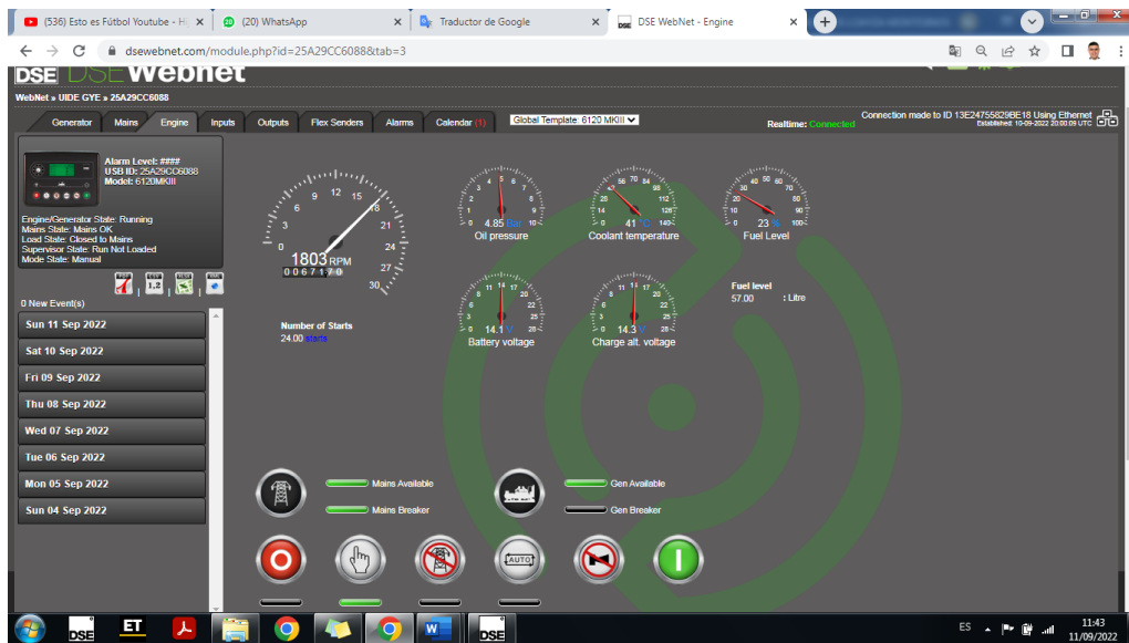
Figura 47 Pantalla de Parámetros del Motor y los Botones de Control.
