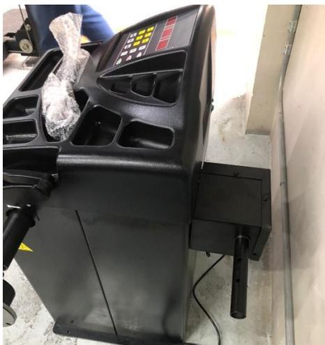
Se instaló el marco de la capucha en el equipo. Además, se colocó el tubo de la campana de protección en el soporte de la capucha, luego fije con tornillos M10×65 (figura 44).
