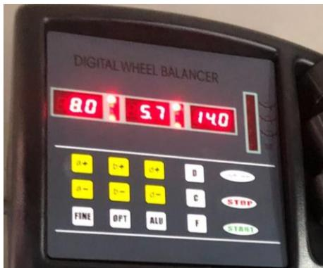
**Datos del Método de Entrada de la Rueda Modo de equilibrio normalmente dinámico.** Después de encender la máquina, ingresa al modo de equilibrio normal. Colocar los datos del aro (Muth, 2022).
