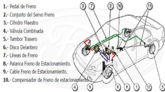
Figura 1. Partes del mecanismo de freno
