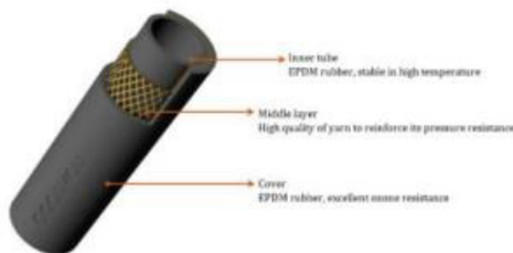
Figura 5. Manguera o cañería de freno flexible. [11]
