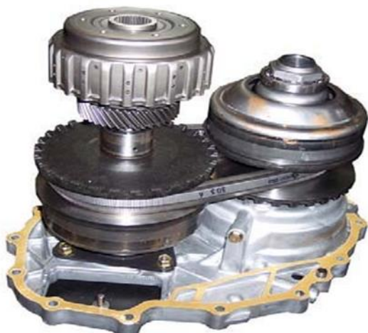
CVT de Poleas con Diámetro Variable
