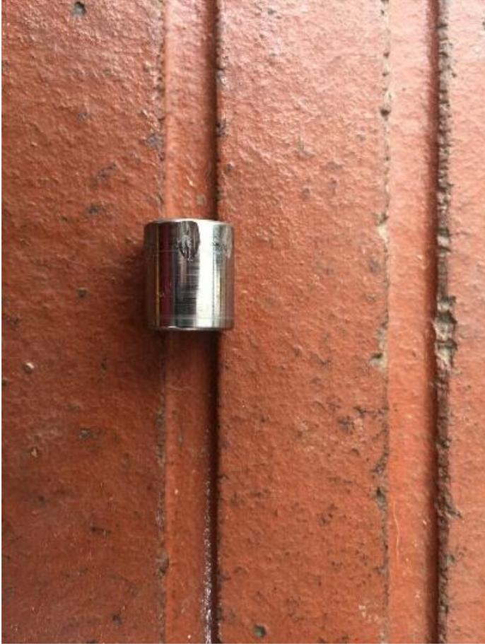
*Nota:* Cilindro de prueba de acero cementado con desgaste proporcional a temperatura, lubricante y fuerza aplicada. Tomado de autor, 2021
