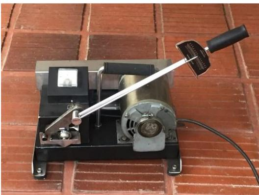
*Nota:* Representa la maquina mecánica la cual permitió ver el desgaste del material con lubricación.
