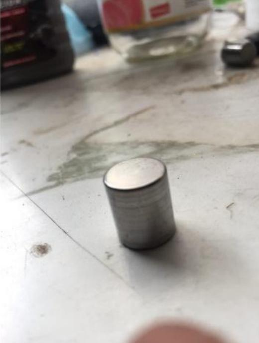
*Nota:* Cilindro de prueba de acero cementado sin desgaste. Tomado de autor, 2021
