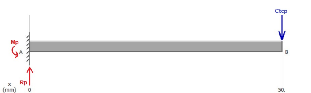
Figura 4: Diseño por Resistencia de Plataforma de la Cámara: Diagrama de Cuerpo Libre
