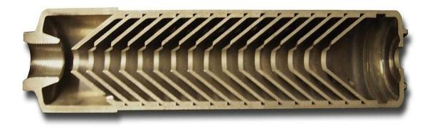
Nota: Silenciador tipo diafragma con 15 cámaras que atrapan los gases. T Tomada de "Silenciador" [Fotografía]. (La Armeria, 2019)
