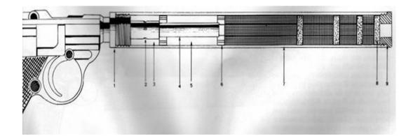
Nota: 1- Manguito, 2- Orificios de escape, 3- Cámara de expansión primaria, 4- Cañón, 5-Rollo de red de acero, 6- Deflector, 7- Discos de red de acero, 8- Diafragma elástico, 9- Tapa. Tomada de "Partes del silenciador" [Fotografía] (Serulla, f, 2019)
