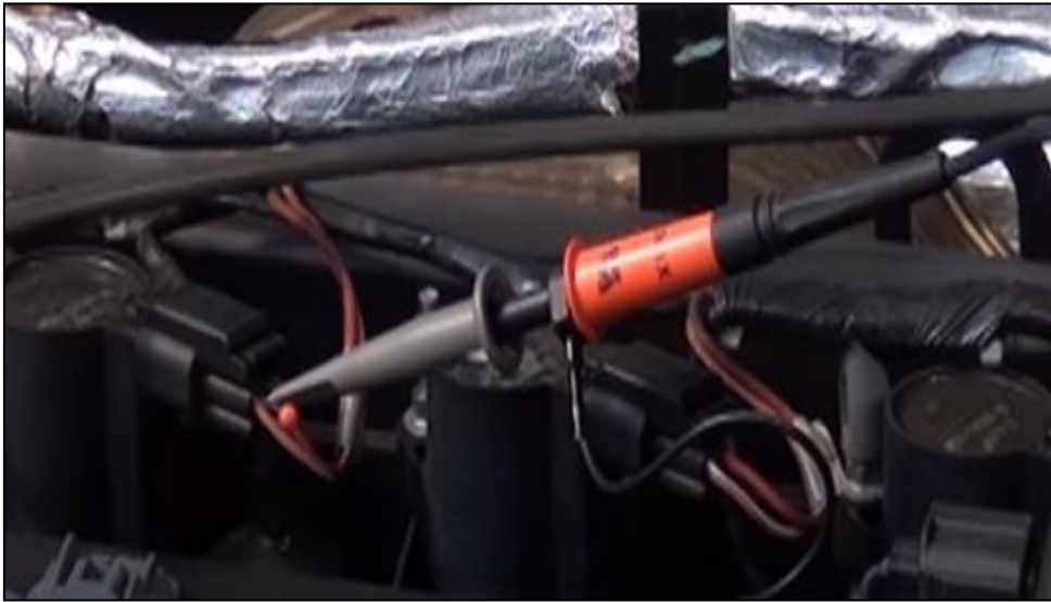
Medición de Voltaje Enviada por la ECM a los Actuadores
