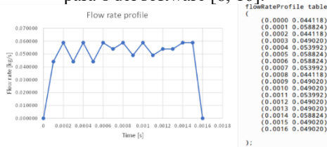
Figura 4. Perfil del flujo másico de la inyección con 17 datos de entrada para la simulación.
