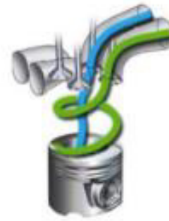
Figura 3.2. Turbulencia del aire en admisión (Swirl)
