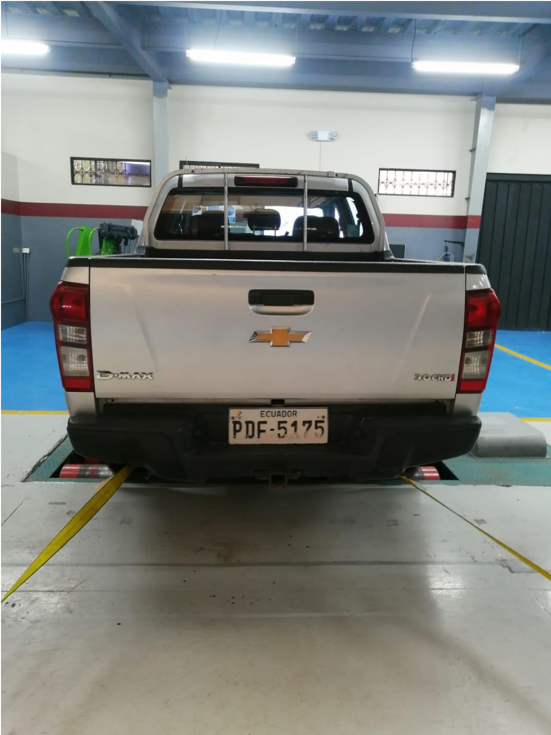
Ilustración 21. Procedimiento para Asegurar vehículo al Dinamómetro
