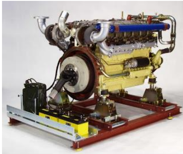
Motor en bastidor para conectar a banco de potencia.
