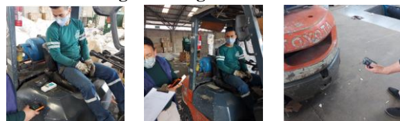
Figura 9. Registro fotográfico de medición de gases con gasolina
