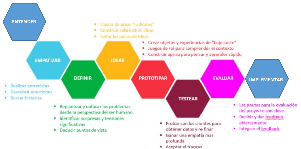
Figura 6. Pasos Metodología Design Thinking. Adaptado de Adiós a los mitos de la innovación (p. 249), por Mario Morales, Guatemala, Innovare.
