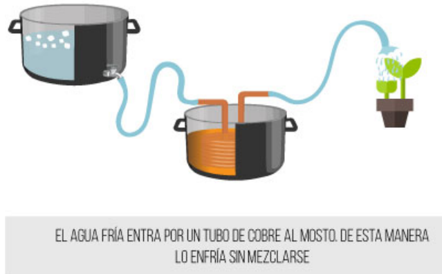
Figura 18. Enfriamiento del mosto por inmersión [10].
