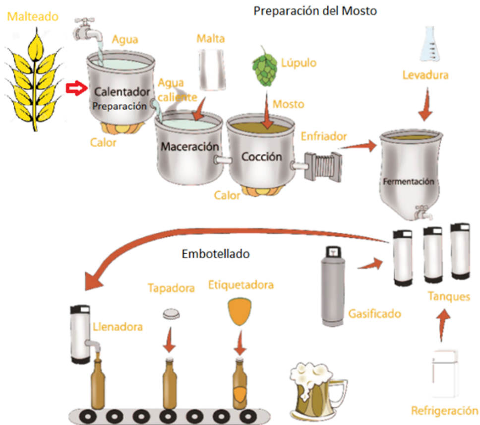
Figura 12. Proceso de fabricación de cerveza [9].
