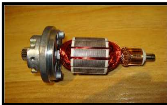
Figura 18: Rotor de un motor DC de imanes permanentes
