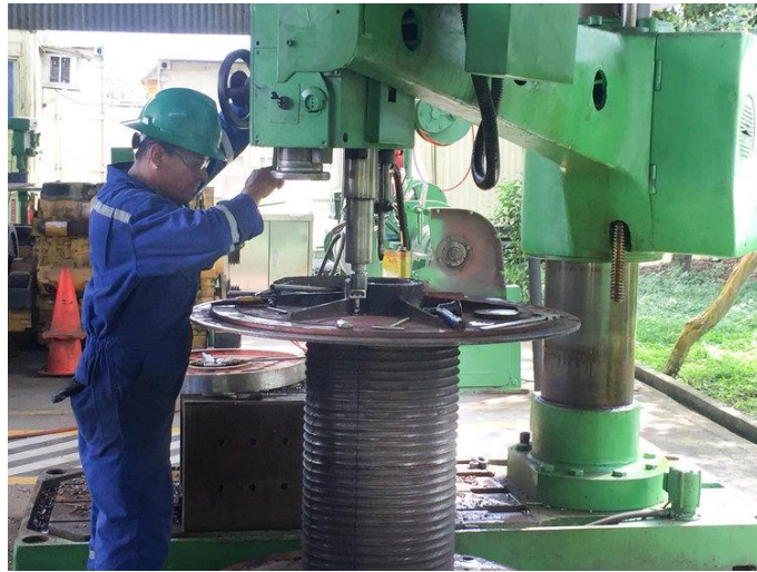
Figura 35. Tornero operando taladro radial
