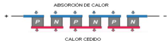
Figure 9: Semiconductores N y P en célula Peltier. (Sacristán Gómez, 2011).
