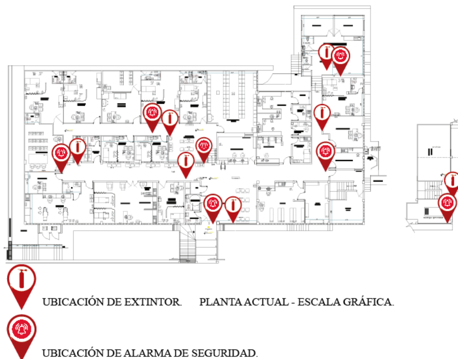
Ilustración 55. Ubicación de extintores y alarmas de seguridad.
