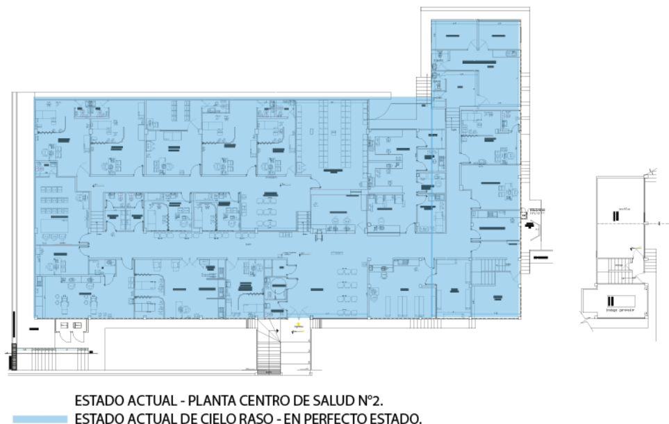
Ilustración 53. Estado de cielo raso - Centro de Salud N°2.
