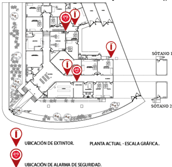
Ilustración 34. Ubicación de extintores y alarmas de seguridad.
