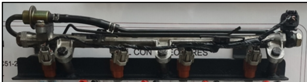
Figura 28. Riel de inyectores
