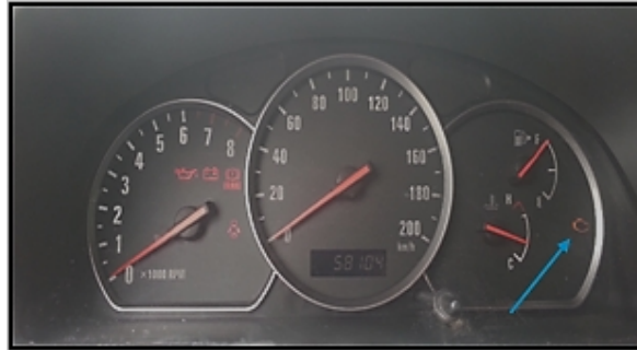
Figura 35. Ubicación de la luz indicadora de avería en el tablero
