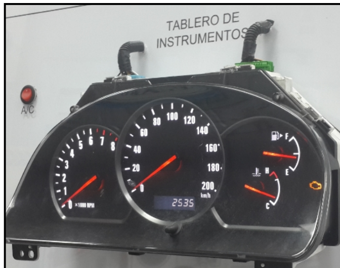
Figura 57. Instalación del tablero de instrumento
