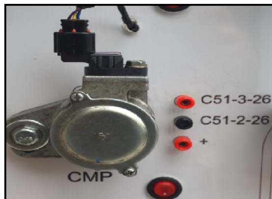
Figura 67. Montaje del Sensor CMP
