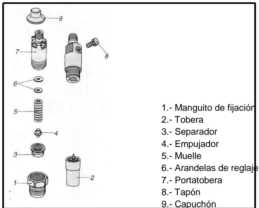
Figura 9. Inyector con regulación por arandelas
