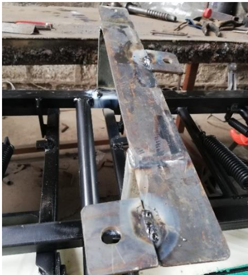
Soldadura de las Bases del Asiento
