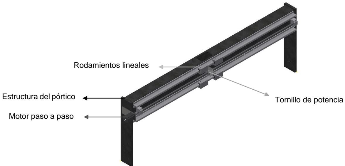
Figura 21. Estructura del eje X
