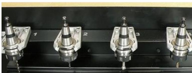
Figura 16. Sistema para el cambio de herramienta automático
