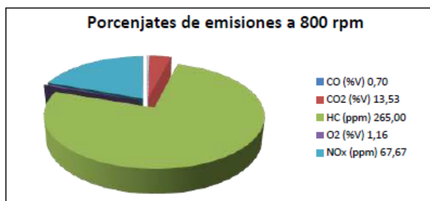
Figura 4-7 Análisis de emisiones contaminantes con súper a 800 rpm
