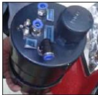
Figura 2-6 Depósito del electrolito
