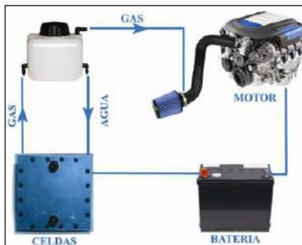
Figura 2-3 Diagrama de inyección de hidrógeno Fuente: (Merino, 2013)
