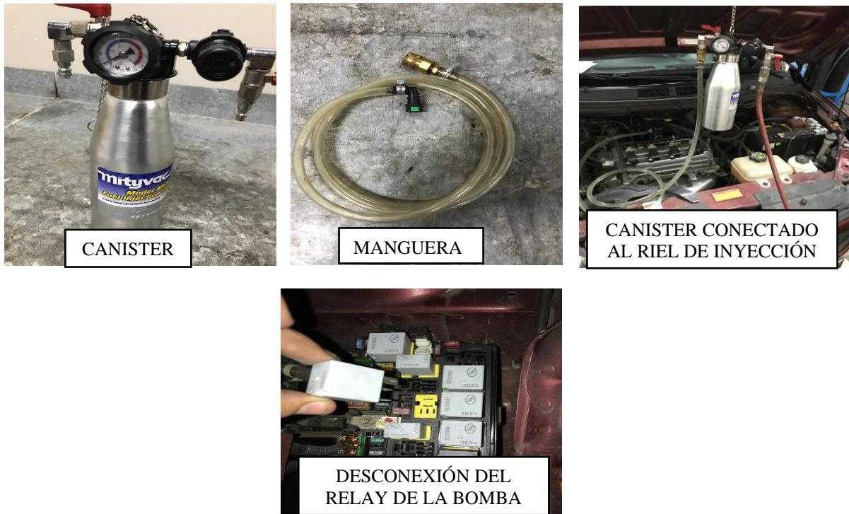
Figura 20. Canister, Manguera, canister conectado al riel del motor, desconexión del relay de la bomba de combustible.
