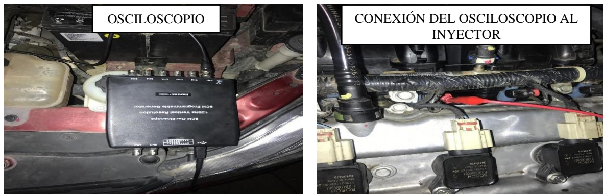
Figura 32. Osciloscopio y conexión al inyector y sensor de oxígeno.
