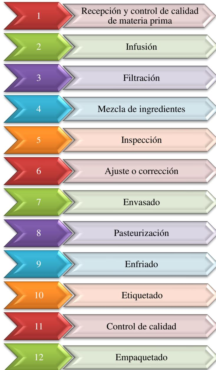
Ilustración 24: Diagrama del proceso de producción
