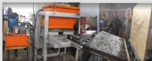
Figura 18. Máquina para fabricar plaquetas de hormigón
