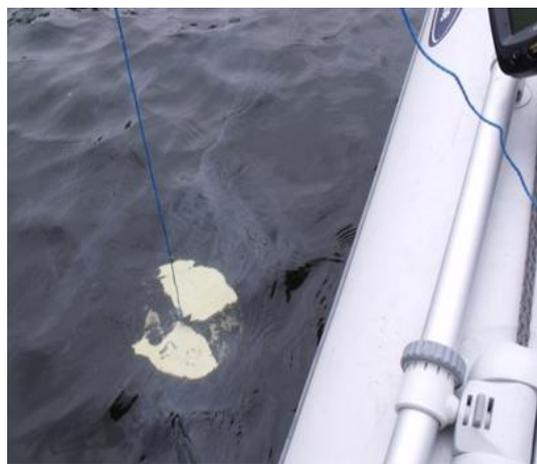
**Figura 6.** Disco Secchi (sumergido).
