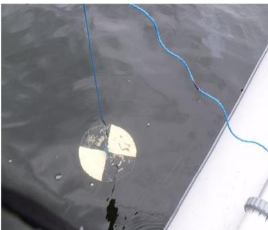
**Figura 5.** Disco Secchi (superficie).
