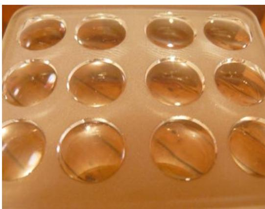
**Figura 11.** Placa cóncava para observación de muestras. Cada hendidura contiene 100  $\mu$ L que son analizados por partes y de esta manera se obtiene el conteo real por cada gota.
