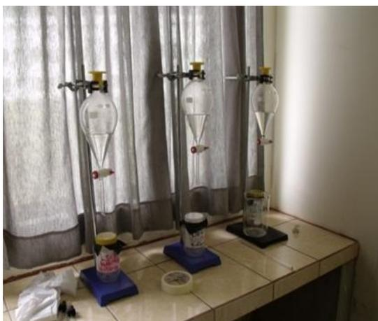
**Figura 9.** Embudos de decantación. Se utilizaron principalmente cuando la carga de sedimentos en las muestras era alta, de esta manera se separa la mayor parte de sedimentos hasta en un máximo de 72 horas.
