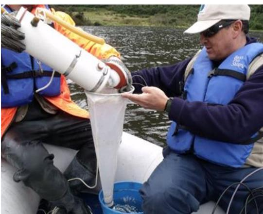
**Figura 3.** Recolección con Botella Van Dorn, se observa también la malla de filtración para obtener el fitoplancton.
