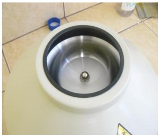
**Figura 10.** Centrífuga. Este aparato se utilizó solamente para muestras que presentaron menor cantidad de sedimentos y así acelerar el proceso de sedimentación de la muestra.
