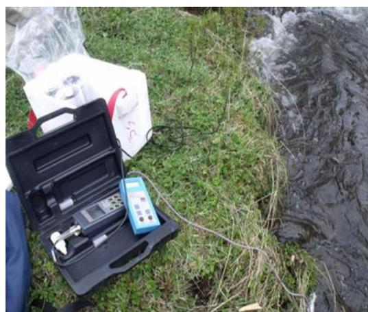
**Figura 8.** Equipos utilizados para la toma de datos. En la Figura se puede observar el medidor de oxígeno y el multi-parámetros, el primero para los datos de oxígeno disuelto solamente y el segundo para conductividad, pH y sólidos disueltos.
