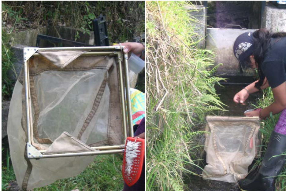
Figura N° 2.- Red Surber utilizada como método cuantitativo para la captura de plancton.
