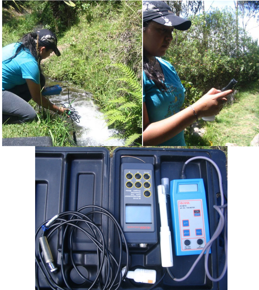
Figura N° 4.- Equipos utilizados en campo (oxigenómetro, multiparámetro y termómetro) para la determinación de valores físico-químico del agua en los nueve puntos de muestreo.
