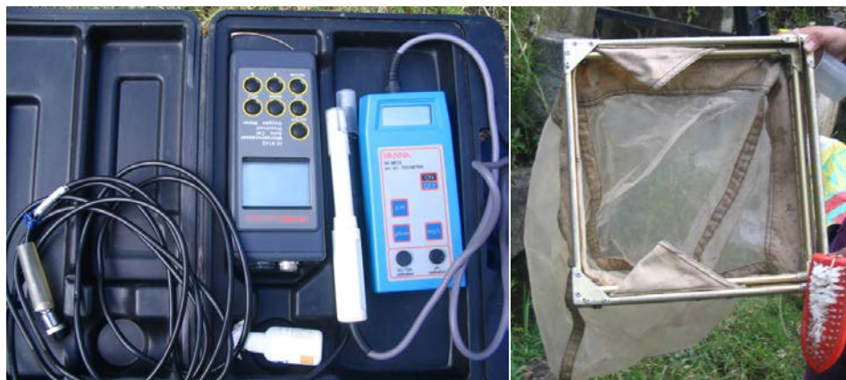
Figura N° 5: Oxigenómetro y multiparámetro. Figura N° 6: Red Surber.
