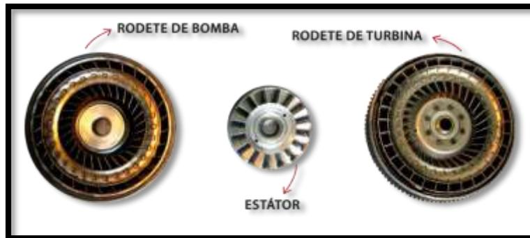
*Figura 12.* Partes del convertidor de par
