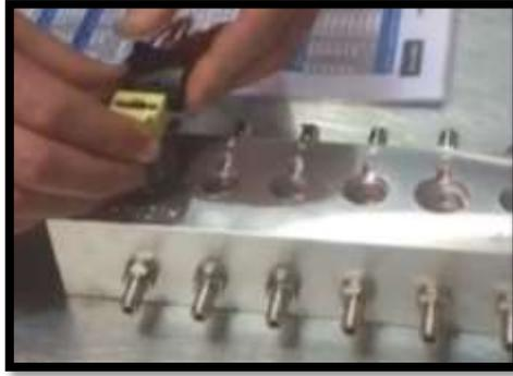
**Figura 51.** Solenoide instalado en el block de prueba
