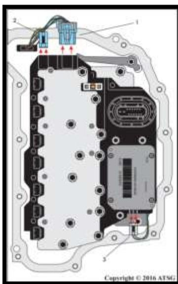
**Figura 65.** Ubicación de los interruptores para los sensores de posición, velocidad de entrada y salida (ATSG, 2018)
