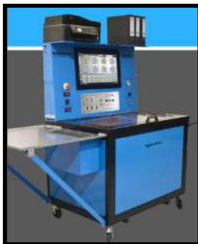
*Figura 28.* Máquina de prueba para cuerpo de válvula
