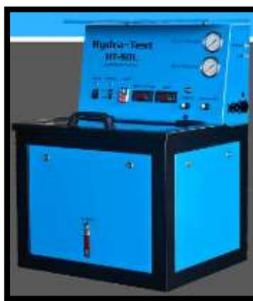
*Figura 48.* Máquina para probar solenoides
